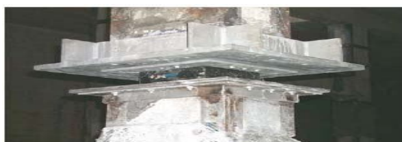
شکل ۸-۸. جداگر لرزه‌ای یا ایزولاتور
