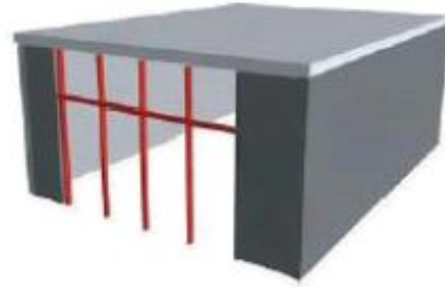
الف- اضافه کردن دیوارهای سازه ای
