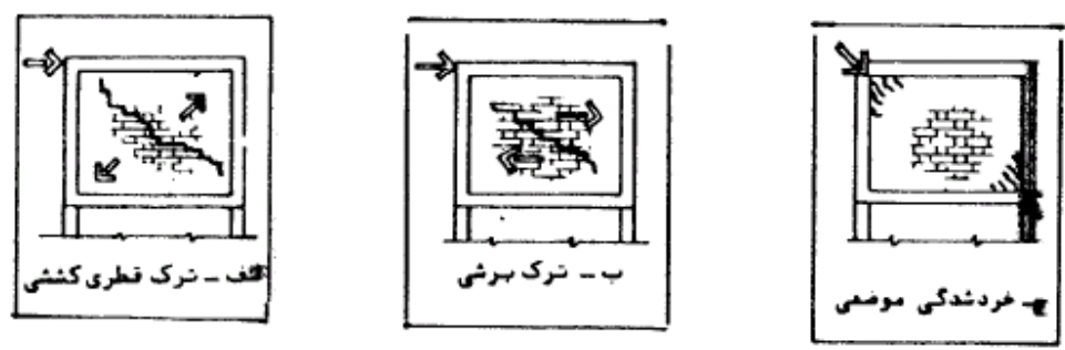
انواع گسیختگی دیوارهای محصور شده در قابها
