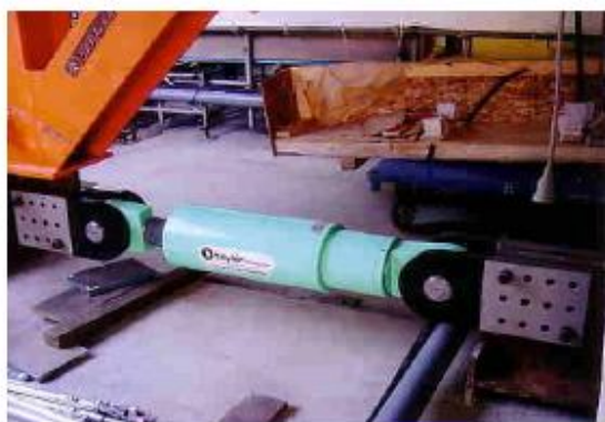
نمونه ای از کاربرد میراگر سیال لزج
