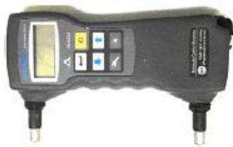
نمونه دستگاه تستر اولتراسونیک مورد استفاده
